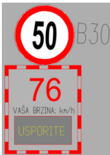
Slika 12. Izgled prometnog znaka s preventivnim radarskim mjeračem brzine (izgled finalnog proizvoda može odstupati od prikazanog)
