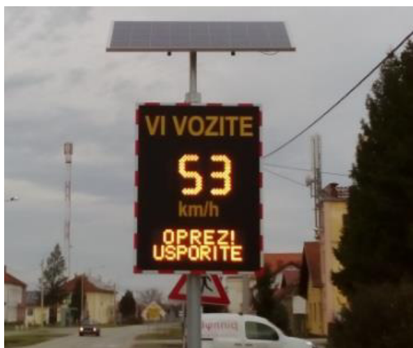
Slika 14. Izgled preventivnog radarskog mjerača brzine dimenzija 640 x 750 x 100 mm
